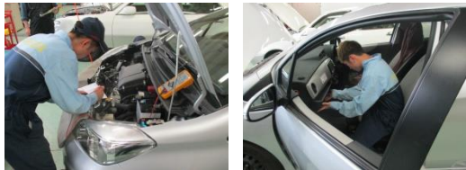
写真5 電気系統の点検
