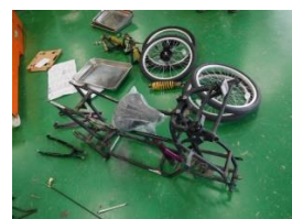
写真2(左) 四輪バギーのフレーム加工
