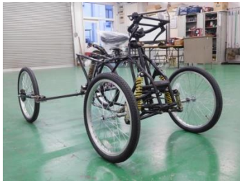
写真6 シャシフレーム完成
