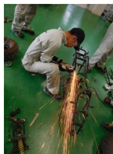
写真2(左) 四輪バギーのフレーム加工
