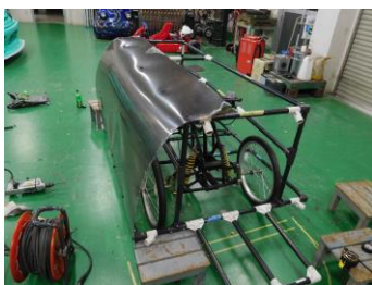
写真7 塩ビとポリカによるボディフレーム
