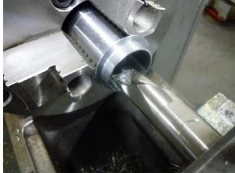
写真5 ディスプレーサキャップの加工
