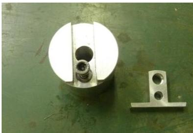
写真4 軸受ブロック加工用治具(写真左)
