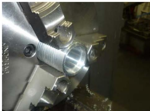
写真6 冷却シリンダのめねじ加工
