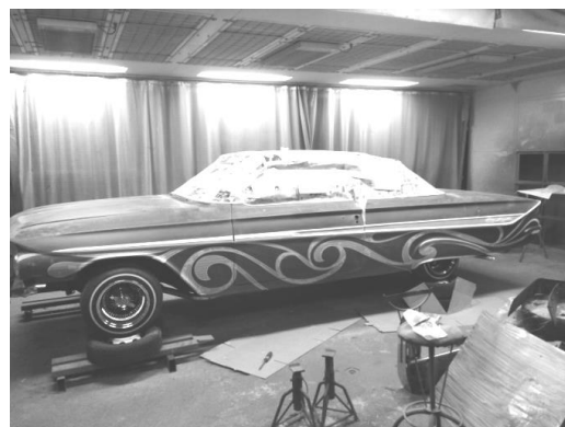
写真2 マスキング作業風景
