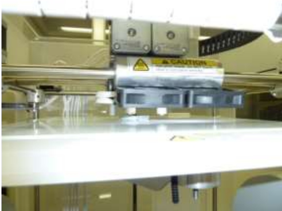
図9 ノズル部拡大 (運転中)
