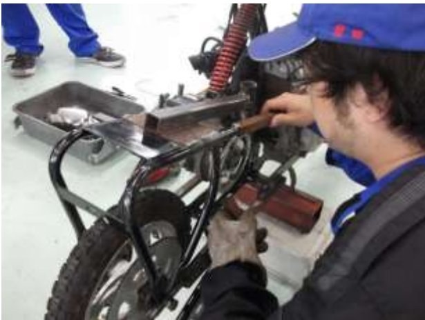
写真3. 切断した車体をボデーに溶接①
